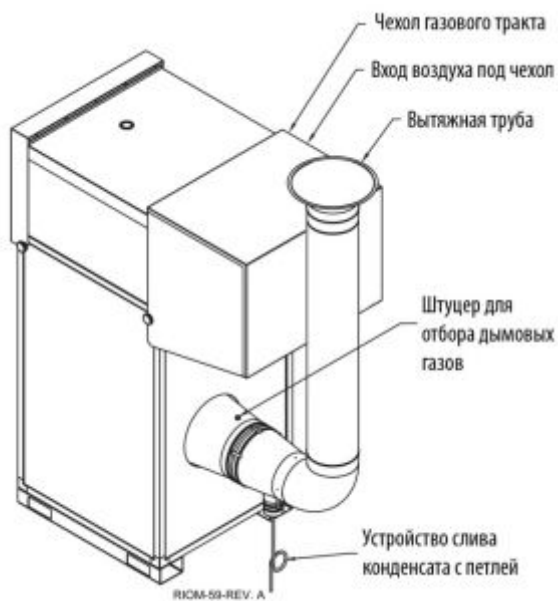
Рис. 9.1. Система дымоудаления котлов/водонагревателей, установленных снаружи здания
