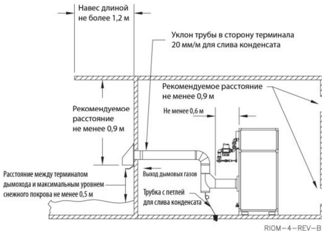
Рис. 7. Выход дымохода через боковую стену
